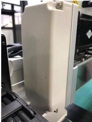
图 4-7 拆卸电机转折组件外盖
