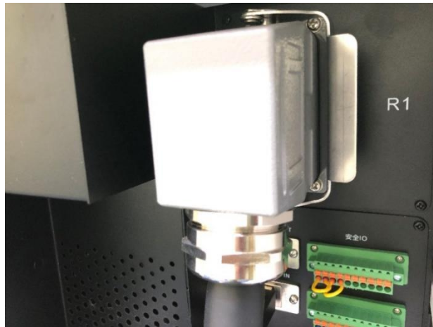
图 3-1 A 型接口连接图
